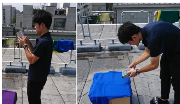
図 2 分光放射計 MS-720（英弘精機製）による被服表面反射スペクトルの観測
